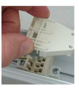
Einklicken des Geräteträgers in die Tragschiene. Darauf achten, dass Geräteträger über gesamte Länge einrastet und keine Kabel eingequetscht werden.
